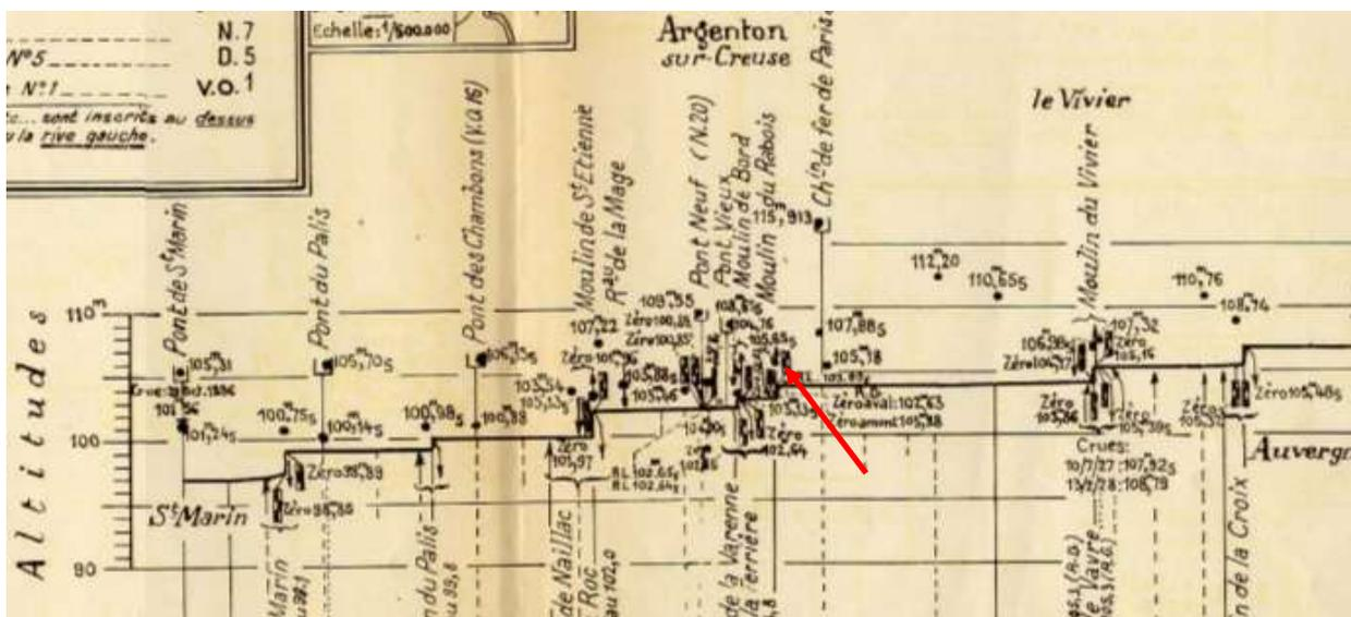
Le profil en long réalisé en 1934 précise les caractéristiques du seuil :
