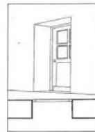
Lorsqu'on ouvre une baie dans un mur ancien, il est important de respecter cette disposition - car la pose d'une menuiserie en fond de baie est inesthétique.
