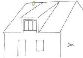
Il faut exclure les lucarnes à double ou triple fenêtre et les grosses lucarnes rampantes en chien-assis qui écrasent le toit sous leur volume.
