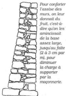
Pour conforter l'assise des murs, on leur donnait du fruit. C'est-à-dire qu'on les aminçissait de la base assez large, jusqu'au faite (2 à 3 cm par m), pour diminuer la charge à supporter par la maçonnerie.
